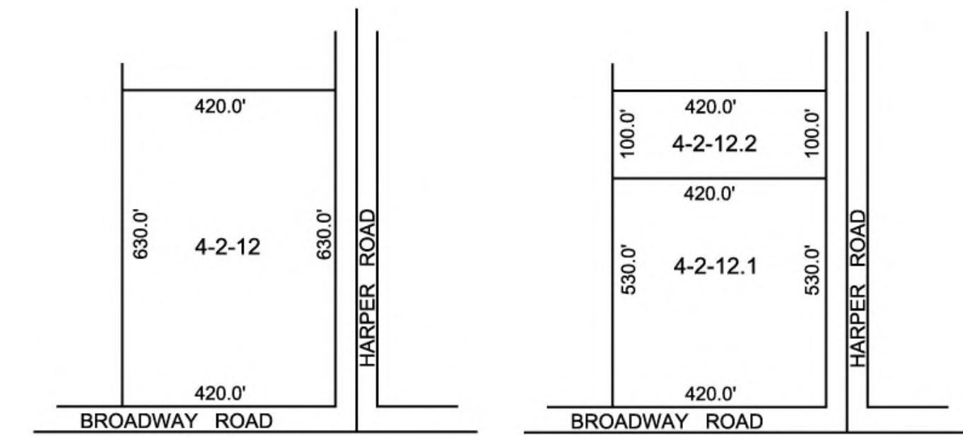
1. SAMPLE PARCEL SECTION-4, BLOCK-2, PARCEL-12.
